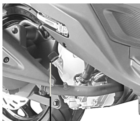
Tampão de enchimento de óleo
