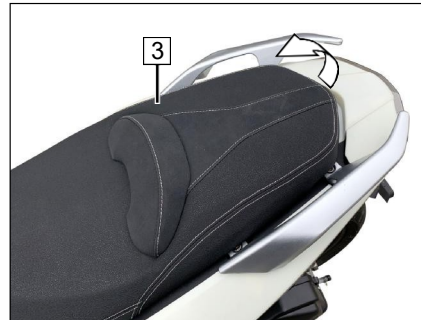
1. Rodar a ignição para "SEAT FUEL" (1), pressionar o botão "SEAT" (2) e abrir o banco (3).
