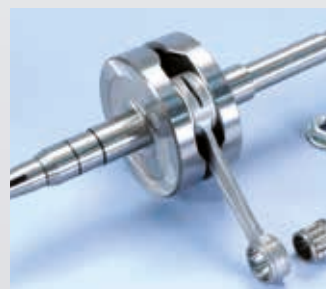
210.0023 Minarelli oriz-horiz. stroke/corsa 44, con.rod/biella 85
