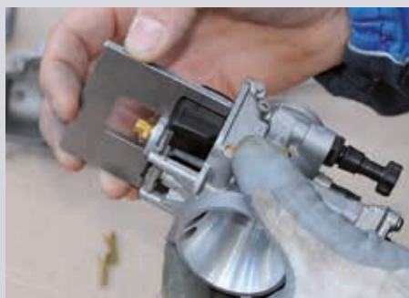
Float level check - Controllo livello galleggiante
