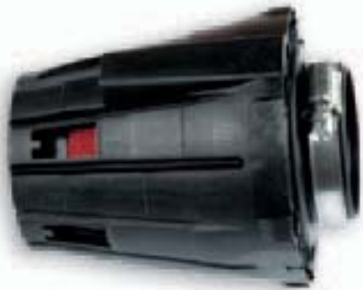
Filtro cónico de espuma. Doble boca: Ø28 / 35 mm. Ref. 803: Recto. Ref. 519: Inclinación 45°.
